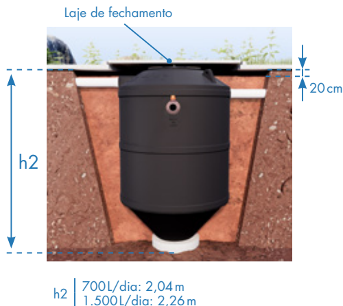
Figura 4 – Instalação com laje de fechamento.
