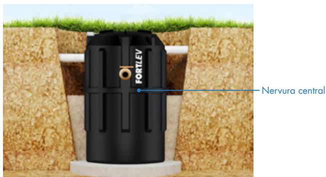
Figura 6 – Aterro com compactação até o início da nervura central.
