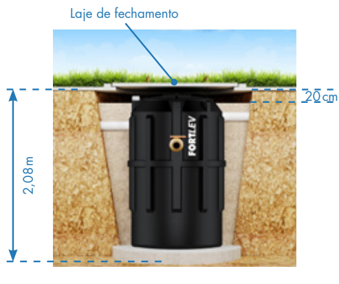
Figura 4 – Instalação com laje de fechamento.
